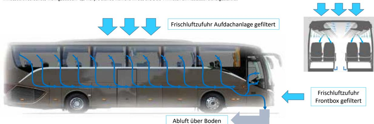
Kompletter Luftwechsel alle zwei bis maximal vier Minuten im Bus mit Aufdachanlage. (Grafik: Evobus)
